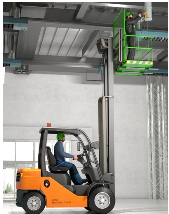
Abb. 2 Flurförderzeug mit Arbeitsbühne
